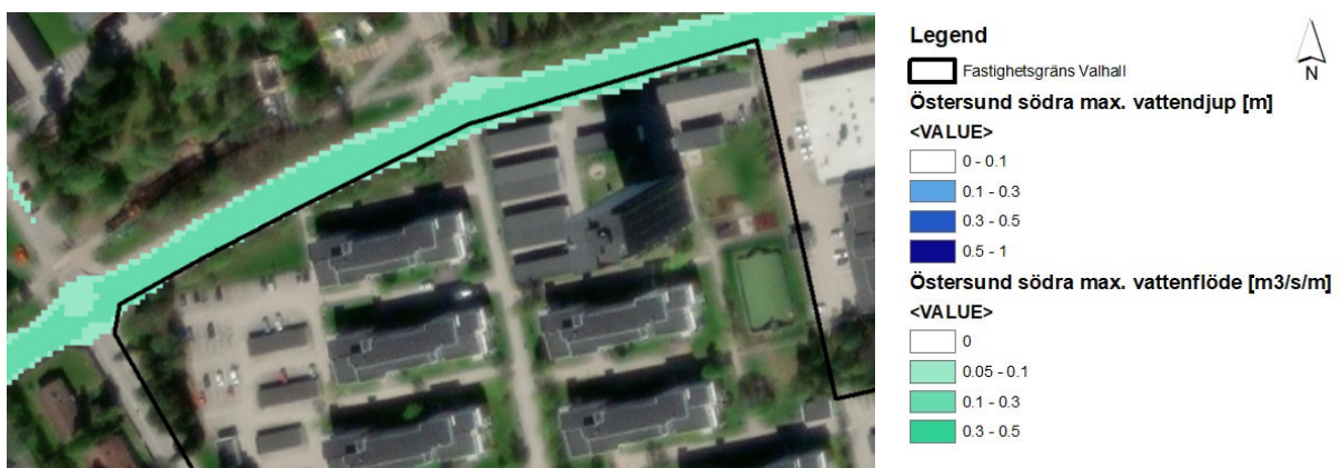
Figur 16. Höga (upp till 0.3 m 3 /s/m) vattenflöden precis vid fastighetsgränsen. Detta är en betydande risk då det kan leda till erosion av marken. Teckenförklaring finns i legenden till höger.
