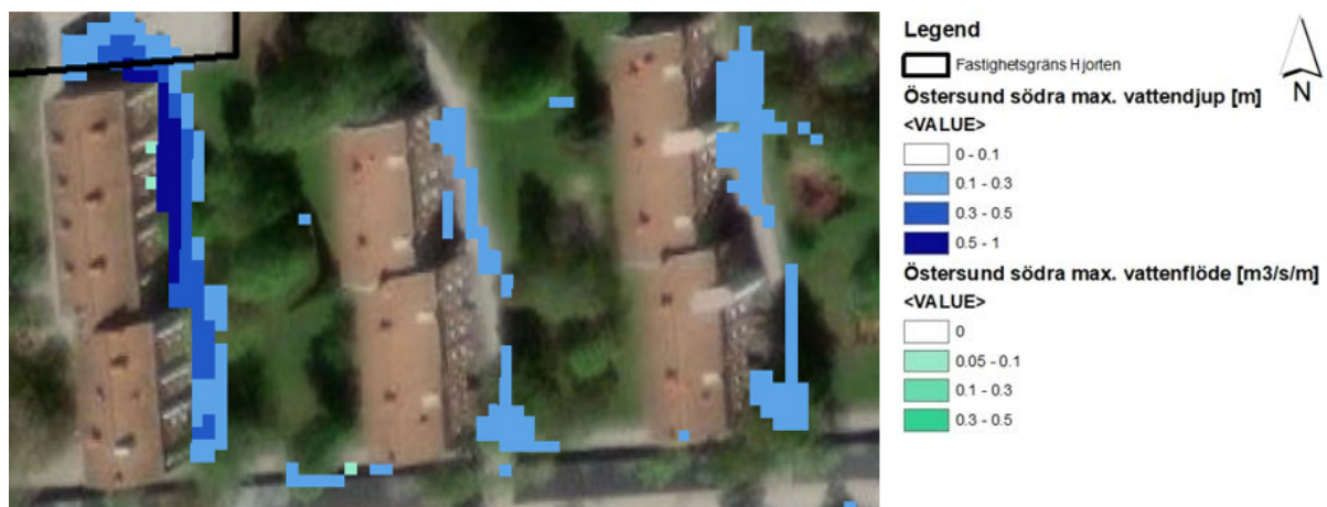
Figur 8. Exempel på byggnader inom området Hjorten där vatten står mot fasad på mellan 0.1 och 1 meter, vilket är en betydande risk.
